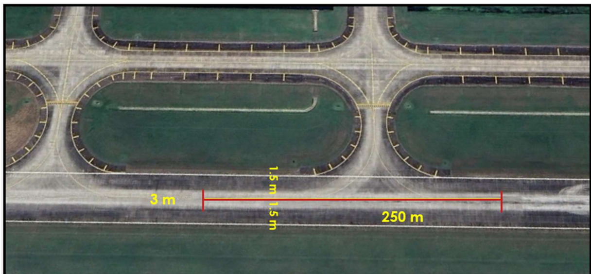
Sección 2: Remoción de Caucho en Pista 04/22 del Aeropuerto Internacional Ramón Villeda Morales
